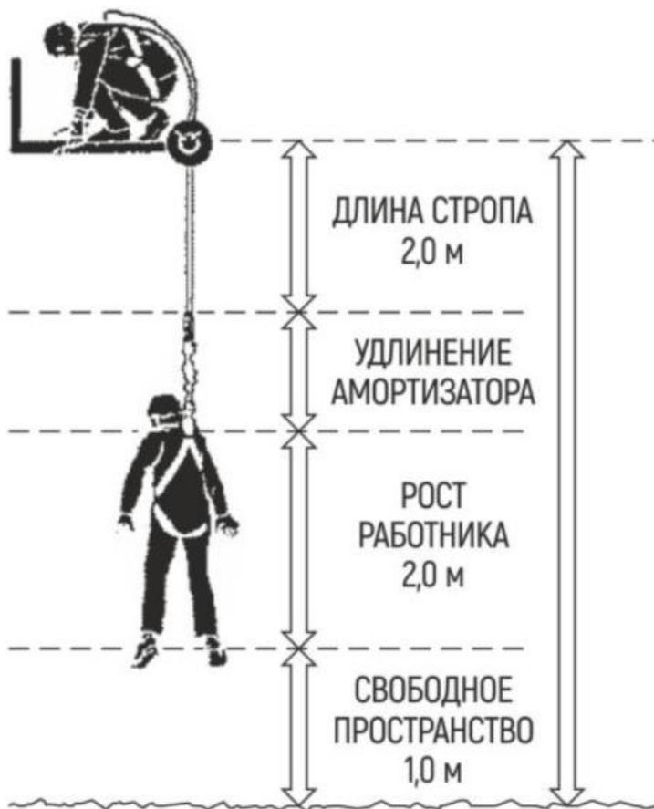
В качестве системы безопасности, в случае, если указанный на стропе **запас высоты недостаточен** для обеспечения безопасности работника, должны использоваться средства защиты ползункового типа на анкерной линии или средства защиты от падения втягивающего типа (блокирующее устройство)
